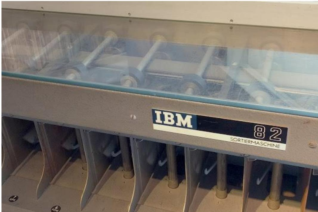
Figure 17: Trieuse de cartes IBM Type 82. Les rouleaux d'alimentation sous le dessus en verre envoient les cartes à travers la trieuse. Les poches en bas rassemblent les cartes. Il s'agit d'un modèle allemand, d'où le label «Sortiermaschine».
