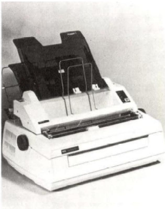
Figure 25: Une imprimante tulipe commercialisé par NFC le Spin Writer avec son dispositif d'alimentation des documents
